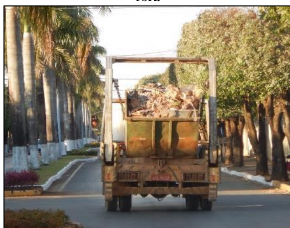
Figura 66. Caminhão poliguidaste de empresa privada utilizado para transporte de caçamba de botafora
