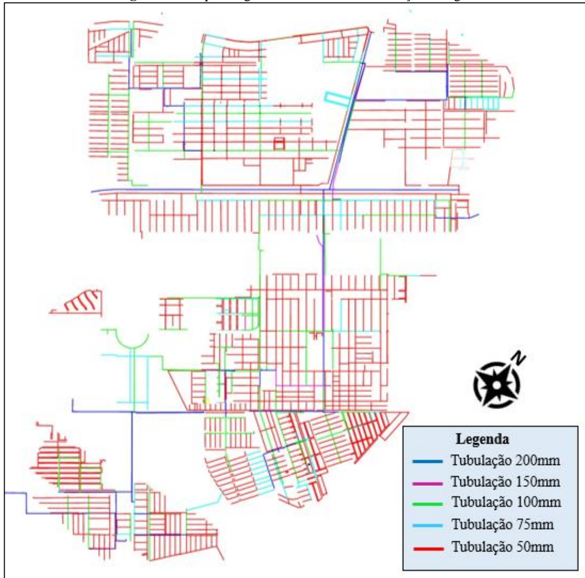
Figura 19. Esquema gráfico da rede de distribuição de água
