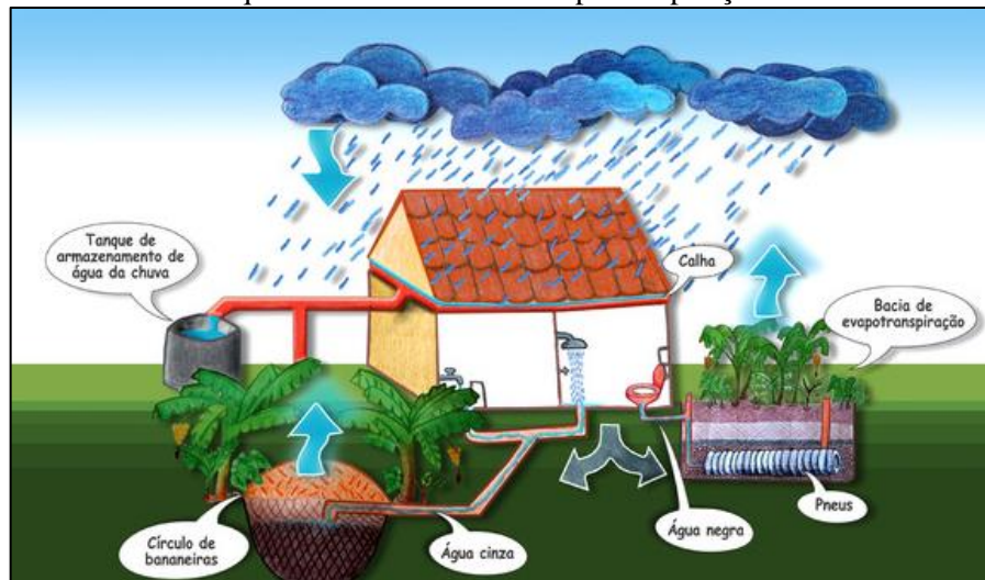
Figura 17. Desenho esquemático da bacia de evapotranspiração e círculo de bananeiras
