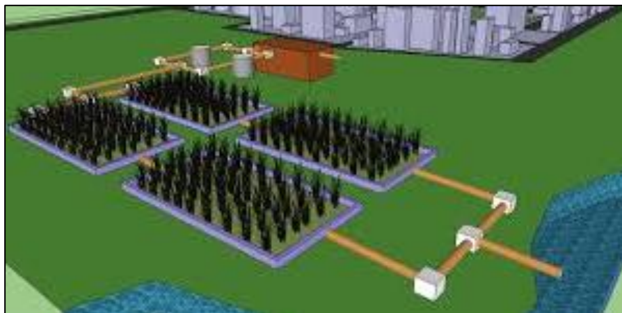
Figura 18. Sistema de tratamento individual utilizando zonas de raízes
