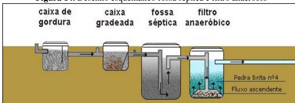
Figura 14. Desenho esquemático fossa séptica e filtro anaeróbio
