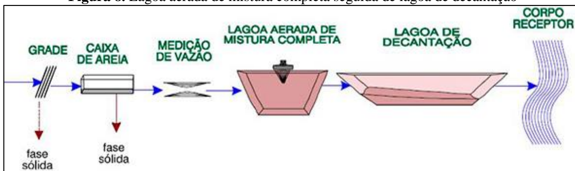
Figura 8. Lagoa aerada de mistura completa seguida de lagoa de decantação
