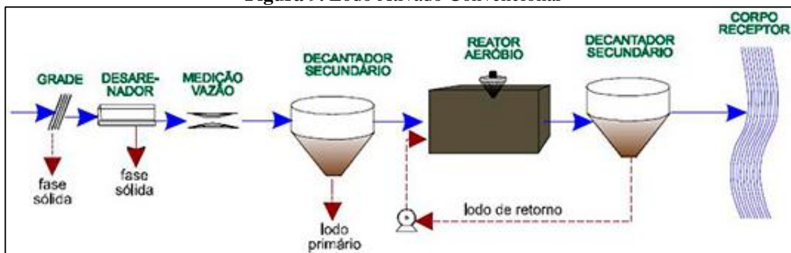
Figura 9. Lodo Ativado Convencional
